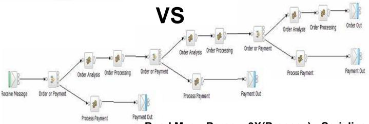
Read Msg - Parse - 3X(Process) - Serialise - Write Msg
